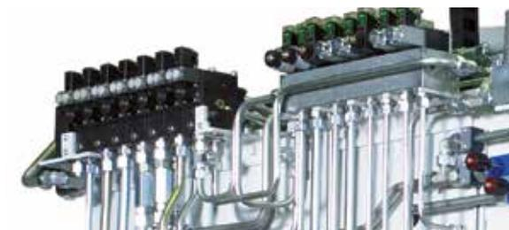
Главные движения машины (движение вибростола, формы, пуансона и загрузочной тележки) приводятся в действие разработанными и изготовленными на ZENITH гидроцилиндрами, управляемыми через пропорциональные вентили. При распалубке можно отсаживать камни с регулируемой скоростью.
