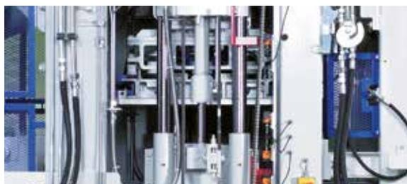
Направляющие пуансона большого диаметра, широкая приводная цепь и рычаг гарантируют устойчивое и точное движение формы и пуансона. Также опционально возможна установка системы измерения хода всех главных движений посредством линейного цифрового измерителя.
