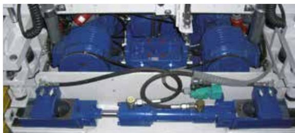
Для быстрой замены формы основная плита пуансона может оборудоваться гидравлически приводимым в действие устройством быстрой замены штампа. При изготовлении бордюров поперек к направлению загрузки формы, пуансон можно чистить с помощью опционально устанавливаемого устройства поворота штампа.
