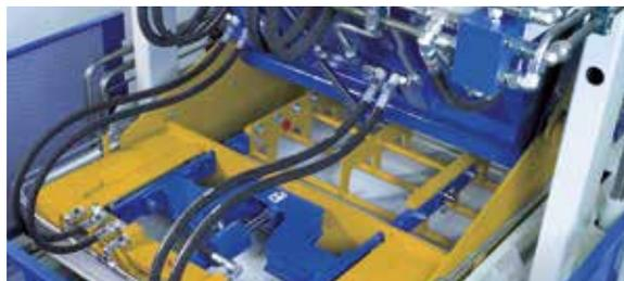
Для более быстрого и лучшего заполнения формы в загрузочной тележке основного бетона можно опционально установить колосники с гидравлическим приводом. Особенно эта опция рекомендуется при изготовлении высоких продуктов и пустотелых блоков с малой толщиной стенок.
