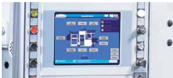
С помощью простой и наглядной в обслуживании панели управления Touch Panel стало очень удобным управление машиной. Производственные параметры для всех форм и производственных рецептов задаются и сохраняются с помощью визуального меню. Для внутренней обработки сигналов применяется технология SPS Siemens.
