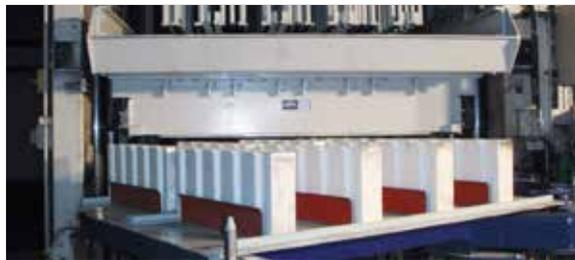
При изготовлении без устройства облицовочного бетона машина дополнительно может оснащаться водным устройством для изготовления блоков с полистирольной вставкой и вращающейся щеткой для очистки поверхности камня.
