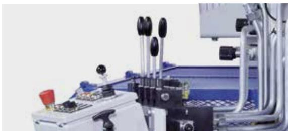
Die Hauptbewegungen der Maschine werden über bewährte SLF-Wegeschieber gesteuert. Bei der vollautomatischen Ausführung sind diese mit zusätzlichen Steuermagneten ausgerüstet und können sowohl automatisch als auch von Hand bedient werden.
