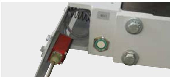
Optional kann Maschine 913 Speed & Comfort ausgerüstet werden mit einer vollautomatischen Fahrspurkorrektur über Ultraschallsensoren.
