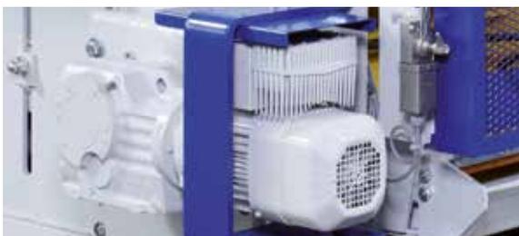
Der elektrische Fahrtrieb mit Frequenzregelung ermöglicht bei Maschine 913 Speed & Comfort ein schnelles und gleichzeitig materialschonendes Vorfahren der Maschine.
