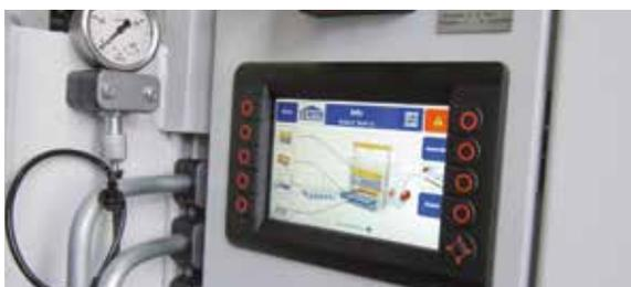
Die vollautomatische Maschine 913 Speed & Comfort ist ausgerüstet mit einer robusten Mobilsteuerung, speziell entwickelt für den Einsatz in mobilen Arbeitsmaschinen. Das Dialoggerät mit Farbdisplay und die übersichtliche Visualisierung erlauben eine einfache Maschinenbedienung.
