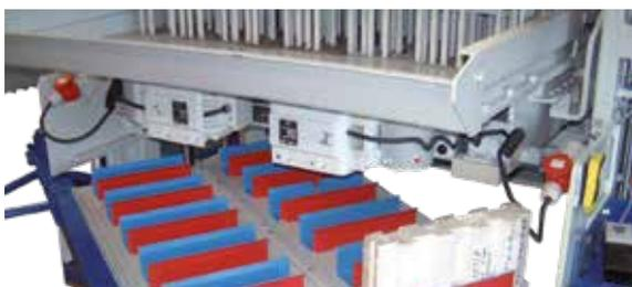
Zur Herstellung von Dämmsteinen kann die Maschine zusätzlich mit einer Einbringvorrichtung für Styroporkerne ausgerüstet werden.
