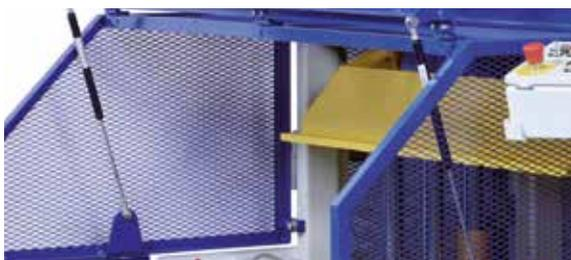
Der mittels Gasdruckfedern aufklappbare Schutzgitterkasten ermöglicht einfache und schnelle Erreichbarkeit des Formenbereichs für Reinigung und Wartung. Stabile und einfach zu bedienende Zugangsverriegelungen gewährleisten die Sicherheit.
