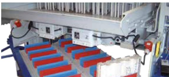
Для изготовления изоблоков, вибропресс дополнительно можно оснастить вводным устройством полистерольного стержня.
