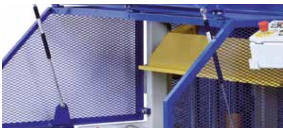
С помощью амортизаторов можно легко поднять защитную решётку для чистки формы и проведения профилактических ремонтных работ. Стабильные и простые в обслуживании запоры, обеспечивают безопасность работы.
