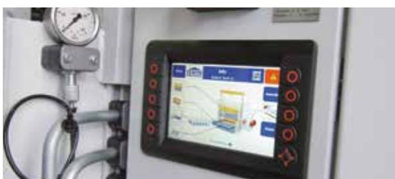
Полностью автоматический вибропресс 913 Speed & Comfort снабжен надёжным мобильным управлением, специально разработанным для использования на передвижных вибропрессах. Пульт управления с цветным экраном и наглядная визуализация, предлагают простое обслуживание оборудования.
