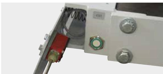
Опционально вибропресс 913 Speed & Comfort может быть снабжён полностью автоматизированной коррекцией полосы движения посредством ультразвуковых сенсоров.
