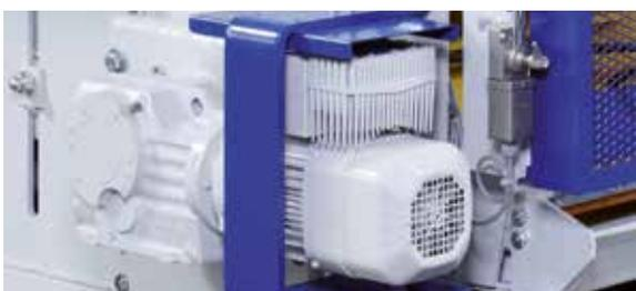
Электрический привод с частотным регулированием на модели 913 Speed & Comfort, предлагает нам быстрое и одновременно безопасное передвижение вибропресса.
