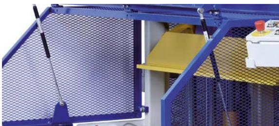
Les ressorts à gaz de la cage protectrice permettent l'accès facile et rapide de la zone de moule pour le nettoyage et la maintenance. La sécurité est garantie grâce aux verrouillages robustes et faciles à contrôler.
