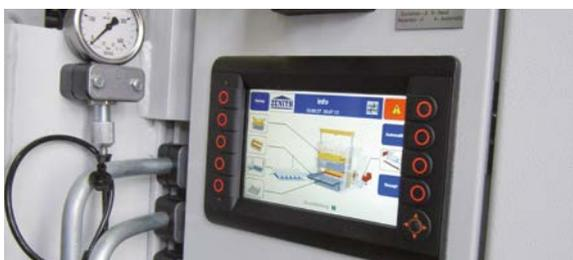
La machine 913 Speed & Comfort entièrement automatique est équipée avec une commande robuste, spécialement développée pour l'utilisation avec des machines mobiles. Le module de dialogue avec l'écran de couleur et la visualisation clairement arrangée permettent un accès facile pour l'opérateur.
