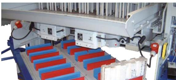
Pour la production de blocs d'isolation, on peut équiper la machine avec un dispositif d'insertion pour le placement de pièces de polystyrènes.
