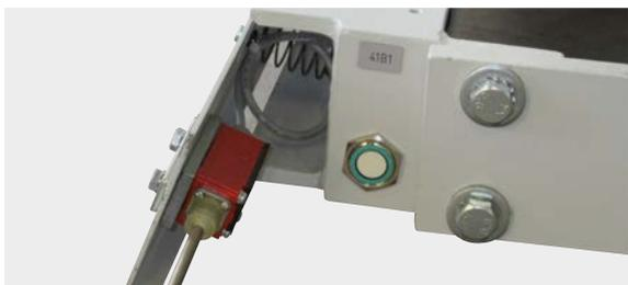
L'unité d'entraînement électrique avec réglage de fréquences de la ZENITH 913 Speed & Comfort permet un mouvement rapide et doux de la machine. Avec cette modèle il y a aussi la possibilité d'équiper la machine avec un dispositif à ultrasons pour corriger automatiquement la direction de production pendant l'opération.
