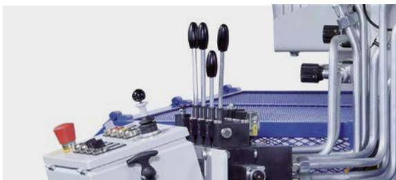
Les mouvements principaux de la machine sont contrôlés par des vannes SLF éprouvées. Avec la machine entièrement automatique les vannes sont équipées avec l'aimants de contrôle permettant le fonctionnement manuel.
