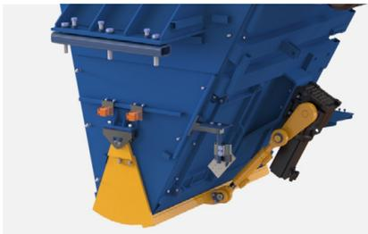
Die Siloklappen der Silos Kern- und Vorsatzbeton sind mit Servoantrieben ausgestattet. Das ermöglicht ultraschnelle Öffnungs- und Schließzeiten, wodurch ein noch genaueres Dosieren erreicht wird. Der Vorteil ist eine bessere Reproduzierbarkeit des Produktionsprozesses, die zu einer höheren Produktqualität führt.
