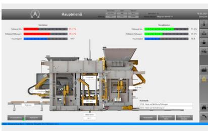
Alle Hauptachsen (Auflast, Form, Füllwagen, Schüttelrost) sind über die Steuerung als geregelte Achsen im TIA-Portal angelegt. Eine externe Regelelektronik ist nicht erforderlich.
