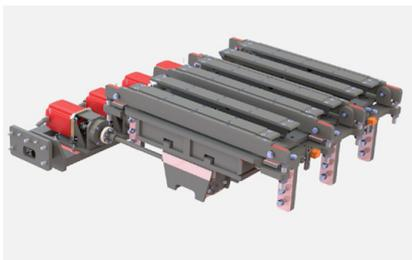
Das Rüttelsystem mit einteiligem Rütteltisch wurde in Zusammenarbeit mit der RWTH Aachen weiterentwickelt. Eine hohe Energieeffizienz wird erreicht durch die optimale Verteilung der Rüttelkräfte. Da dieses System ohne Ölbad auskommt und keine zusätzliche Lüftung erforderlich ist, bietet es außerdem eine hohe Wartungs- und Umweltfreundlichkeit.
